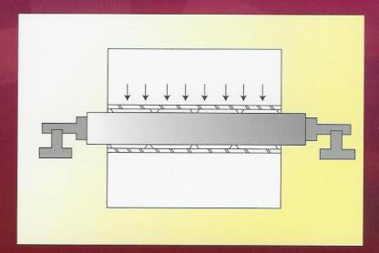
傳統式軸心容易產生彎曲, 且取扱設定尺寸點不易,管端容易造成損壞。
